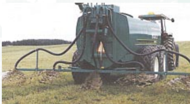
Rampe « pleine terre »
